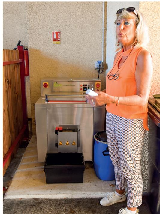
par cycle. Les cycles ont une durée maximale de neuf heures. La durée de chaque cycle est ajustée automatiquement en fonction du poids de déchets. Coût : investissement de 19 000 € HT.
